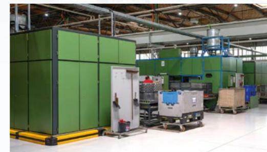
Alle bei der JAHN GmbH hergestellten Produkte werden in modernen Lösemittelwaschanlagen gereinigt.
